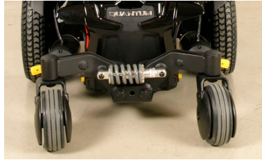
Posisjon for frikobling - skjøvet ned
